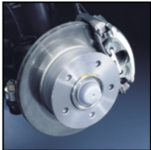
Freno a disco ventilados en las 4 ruedas, con indicador de desgaste de pastillas.
